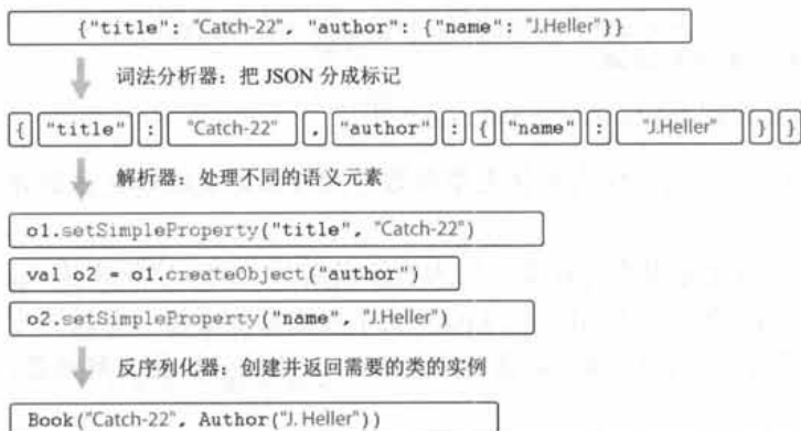
图 10.7 JSON 解析：词法分析器、解析器和反序列化器
