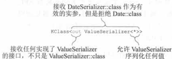
图 10.5 serializerClass 注解参数的类型。指向 ValueSerializer 实现类的类引用将会是有效的注解实参
