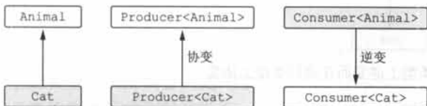
图 9.7 对协变类型 Producer<T> 来说，子类型化保留了，但对逆变类型 Consumer<T> 来说，子类型化反转了
