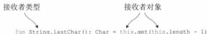
图 3.1 接收者类型是由扩展函数定义的，接收者对象是该类型的一个实例
