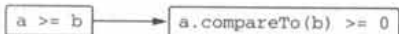
图 7.5 两个对象的比较被转换为 compareTo 的函数调用，然后结果与零比较
